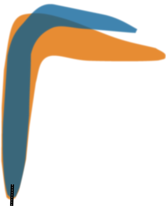
Figuur 6: Indicatie van het verschil in geluidbelasting bij huidige werkwijze (oranje) en nieuwe werkwijze met vaste naderingsroute (blauw).
