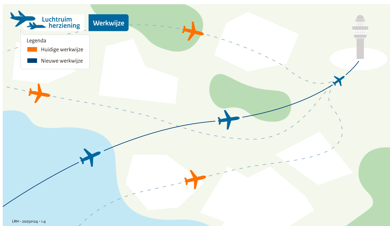
Figuur 1: Bovenaanzicht met huidige werkwijze van vectoren en nieuwe werkwijze middels vaste naderingsroute. Schets is indicatief en niet op schaal.
